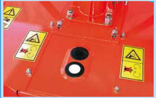
Punto di ingrassaggio Greasing point - Point de graissage Schmierstelle - Punto de engrase
