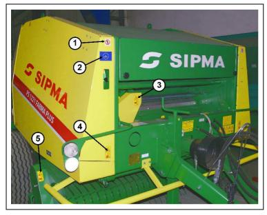
FIG. 27. PICTOGRAMS VISIBLE ON THE FRONT RIGHT SIDE OF THE BALER.
